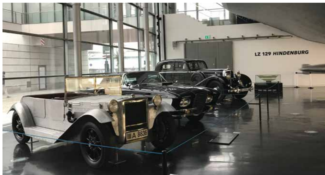
Die unlackierte Aluminiumkarosserie des SHW-Wagens ist ein besonderer Blickfang (Leihgabe Deutsches Museum). © Zeppelin Museum
